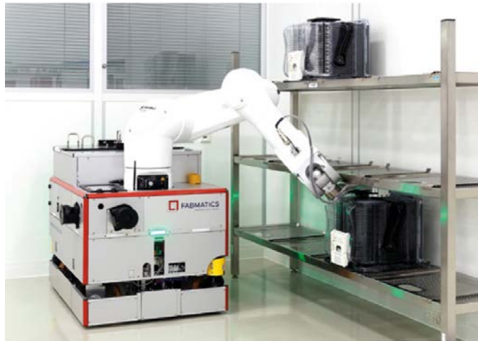
Abbildung 2: Beispiel einer geeigneten Konfiguration für die Realisierung des Konzeptes mit einem Regal als Transferpunkt (siehe www.fabmatics.com )
